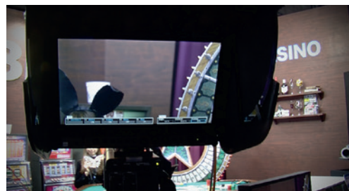
Astro Design : le moniteur DM-3813 affiche des images 4K, pixel pour pixel. Il gère jusqu'à quatre interfaces 3G-SDI, comme celles qu'utilisent les caméras 4K.
