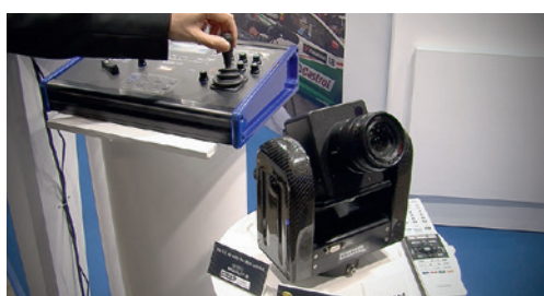
JVC U3_4K : la petite tourelle est réalisée en fibres de verre. Motorisée, elle se programme ou l'on peut la contrôler en temps réel au moyen d'un pupitre de commandes.
