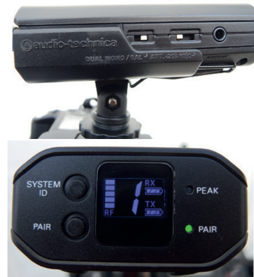
Le flanc gauche du récepteur ATW-R1700 laisse apparaître la sortie audio en minijack 3,5 mm à trois points hélas sans verrouillage, un curseur permettant de choisir soit le mode symétrique TRS, soit le mode Dual mono qui distribue le même signal sur les deux pistes et un autre curseur permet d'atténuer le niveau de sortie de 10 ou 20 dB.
