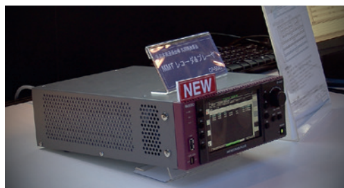
Astro Design MMT Player & Recorder CP-5541 : la transmission des programmes 8K/Super Hi-vision de la NHK est basée sur les conteneurs MMT.
