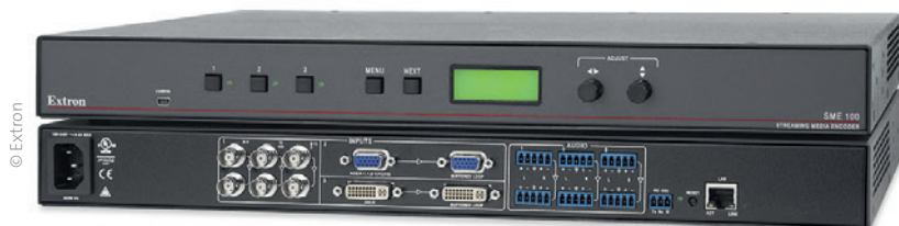
L'encodeur Extron SME 100 avec sa face arrière. Toutes les entrées vidéo et audio sont dédoublées en sonde.
