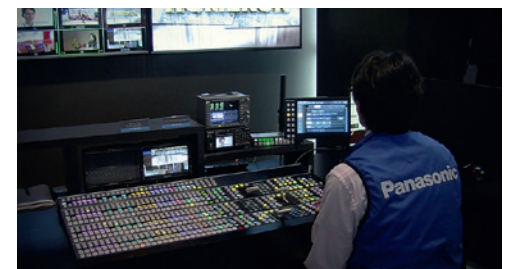
Live Switcher AV-HS7300 : une extension 3ME (Mix/Effects)/4ME est prévue par Panasonic.
