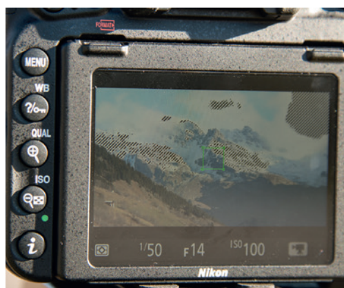
L'affichage d'un zebra aide le réglage du diaphragme.
