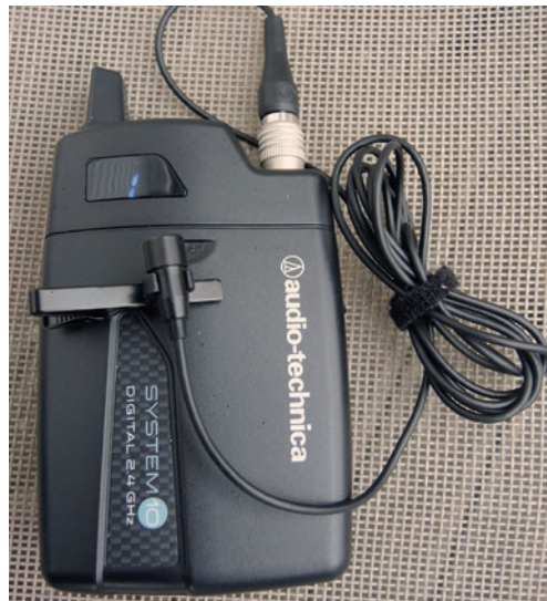
Pour son system 10, Audio-Technica a conservé un système de réglage de niveau par vis. Ici, celui de l'émetteur ceinture ATW-1701. Simple mais un brin rustique pour un produit plutôt Hi-Tech...
