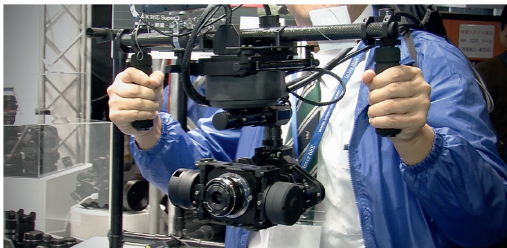
JVC GW-SP100 : le gimbal de la SP100 est doté de différents capteurs : gyro, accéléromètre, champ magnétique, GPS.
