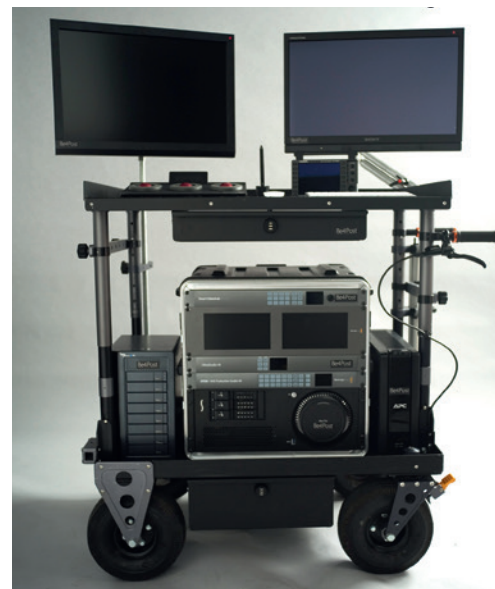
Station B4Post, une station DIT type : possibilité de faire de l'étalonnage live de 2 caméras à 6 caméras, création de LUT, Moniteur sony trimaster OLED H250, sécurisation des rushes sur Tour RAID 5, Transcode multi plate-forme. Le tout est autonome du point de vue énergie, Onduleur 1250W et Batterie 220V et chariot innovatif. Une station complète tout terrain.
