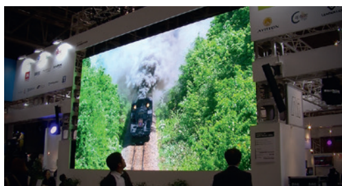
Hibino LED Display Chromavision HCV 16-4K : l'écran est constitué de plusieurs dalles LED, séparées entre elles par un espace contigu de 1,69 mm seulement.
