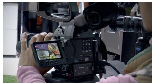
Le viseur du C100 Mark II offre une meilleure résolution et un emplacement moins incongru que la version originale de la caméra.
