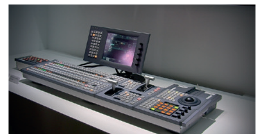
Sony va accentuer les capacités 4K de ses switchers MVS-7000X et 8000X. Il prépare une série d'effets 4K : transitions Wipe, fonction de Resizer 2.5D (2.5D DME), Chroma Key, la transition MIX par bus AUX Wipes...
