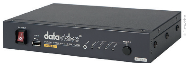
L'encodeur de streaming Datavideo NVS-20 avec son bouton de sélection d'entrées vidéo et de démarrage du streaming. Le port USB sert à enregistrer le contenu émis.
