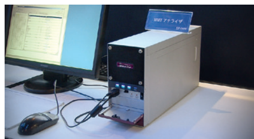
Astro Design MMT Analyzer SP-5800 : Les données MMT sont censées être le protocole de transport à la base de la diffusion broadcast de demain, hertzienne aussi bien que celle via les réseaux « Tout IP » à large bande passante.
