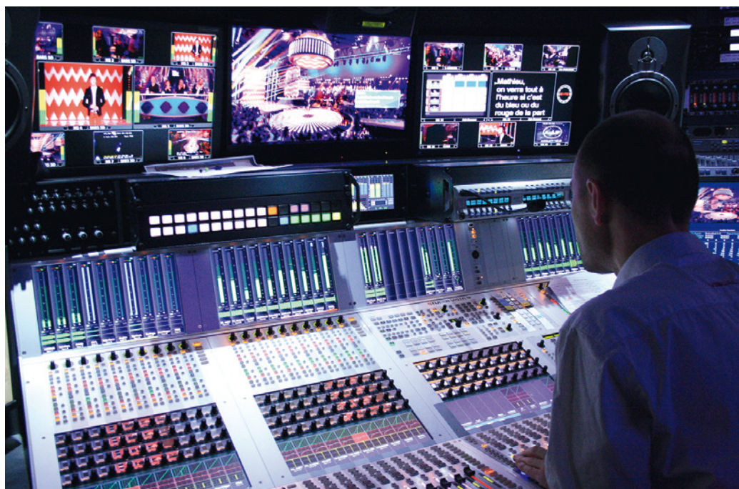
La régie son du Car Millenium 2 équipée d'une console Studer Vista 9.
