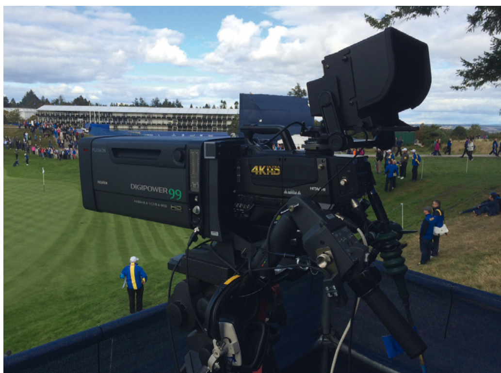
L'Hitachi SK-UHD4000 comporte quatre capteurs Cmos HD, deux verts, un rouge et un bleu.
