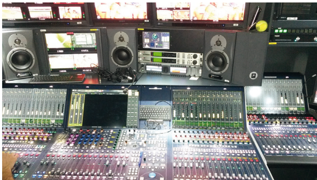
Vue générale sur la régie son du car de Toulouse, Filière France TV Production, équipée d'une console Lawo MC2 53.
