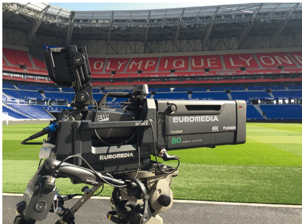
La Sony HDC-4300 en tournage avec un zoom UA80 x 9 Fujinon 4K/UHD.
