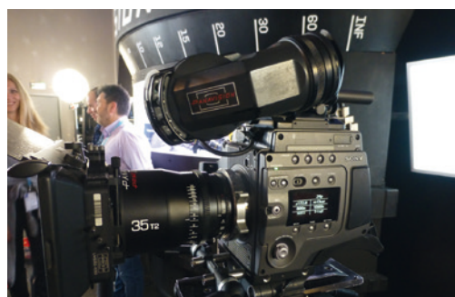
10 - La caméra Sony F65 modifiée par Panavision et équipée d'un objectif 70 mm.
