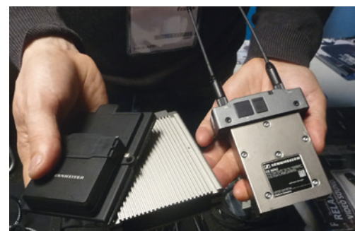
23 - Récepteur enfichable double canal Sennheiser RK 6042 pour caméra et compatible avec les microphones sans fil du constructeur.
