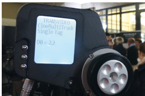
16 - Le CinéMultiTrack permet maintenant de mesurer la distance entre plusieurs cibles.
