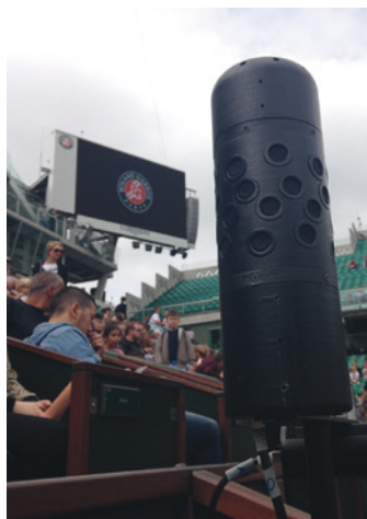
Tête binaurale custom élaborée et mise en place par les équipes de France TV lors de l'édition 2015 de Roland Garros.
