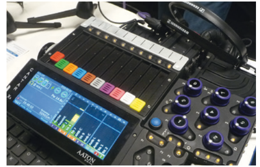
19 - Enregistreur audio numérique 24 pistes emblématique d'AATON, le CANTAR X3, avec fonction mixage intégrée.
