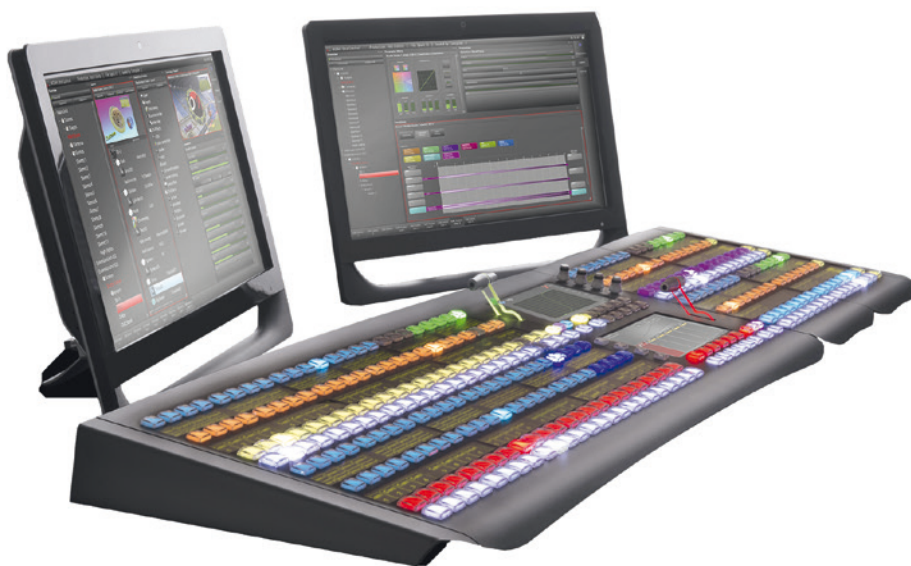
Le mélangeur Dyvi d'EVS associe un pupitre de commande très complet avec des touches totalement ré-assignables et des écrans servant à paramétrer et à combiner les effets gérés par le GPU.
