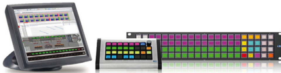
En régie, les équipes de production privilégient l'usage de panneaux à touches pour des actions immédiates et précises. Ce type de pupitre, ici ceux de LSB, récemment absorbé par Lawo, dialogue directement avec les équipements SDI via un orchestrateur. Grâce au SDN, leurs actions agissent aussi vers les actifs réseau.
