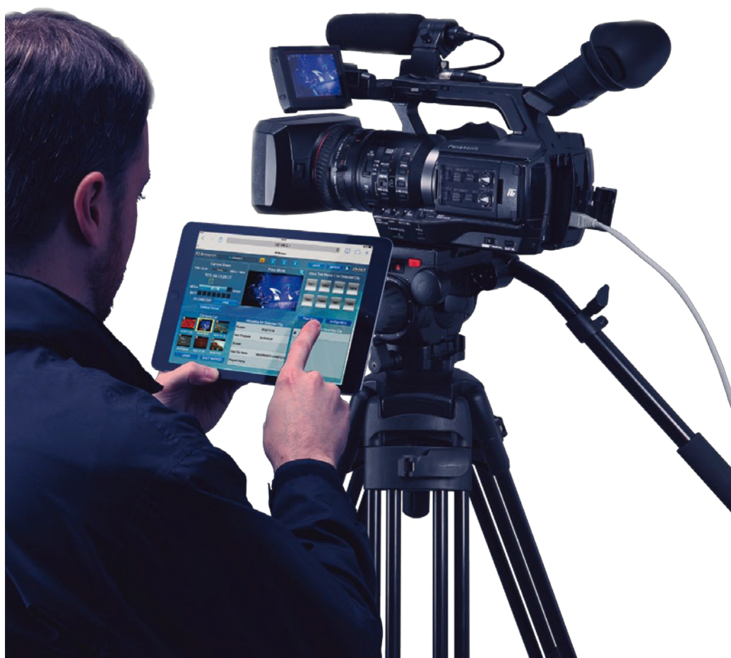
La présence d'une interface réseau sur un caméscope connecté, ici un modèle Panasonic AJ-PX270 permet de le télécommander depuis une tablette et de consulter les séquences enregistrées. © Panasonic
