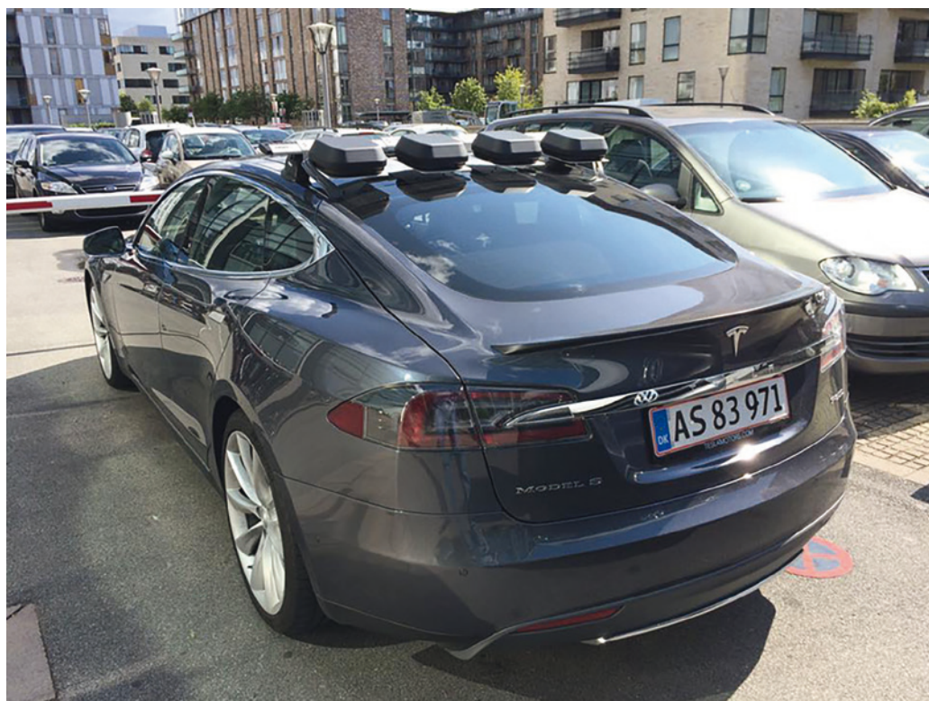
Au Danemark, la chaîne TV2 a équipé une voiture Tesla pour transmettre une interview politique tout en roulant. Sur le toit les quatre antennes d'émission Quad d'Aviwest. © Aviwest
