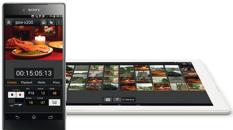
Via une liaison wifi, l'application Sony CBM (Content Browser Mobile) sert à télécommander les réglages du caméscope, à lire les séquences enregistrées et à afficher un retour écran. © Sony
