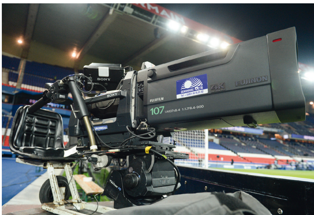
L'ensemble des 15 caméras Sony 4300 déployées autour du terrain est pourvu d'optiques 4K Canon ou Fujinon.
