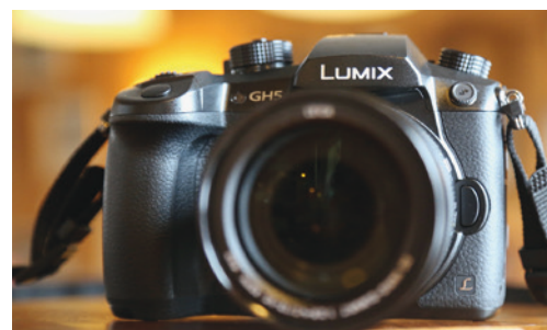
Le DC-GH5 possède un capteur de 20,3 Millions de pixels.
