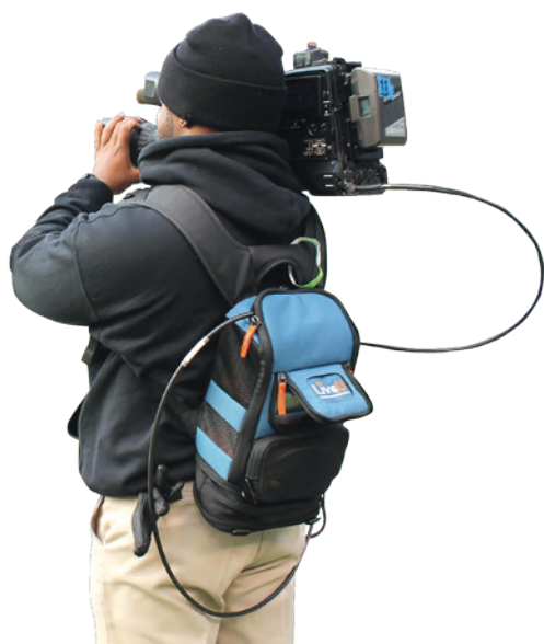
Le dos 4G regroupe un encodeur vidéo, un enregistreur, les modules de transmission avec leurs cartes SIM et une batterie. © LiveU
