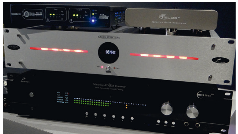
Lumière sur les dispositifs que Fabrice Chantôme aime apporter sur les projets longs pour plus de confort : BSS London Blu-50 utilisé ici pour le processing des enceintes Prosodia, Telos Quantum Noise Resonator pour le filtrage secteur, Horloge Rubidium Atomic Clock et convertisseur Eclipse signés Antelope. Des améliorations qui au final « s'entendent sur les fichiers, mais aussi sur une télévision... »
