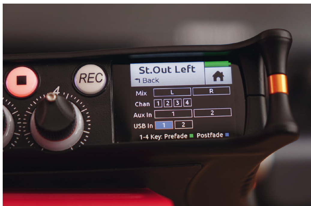
Si l'on souhaite utiliser la MixPre comme interface audio pour « sonoriser » le système ou l'utiliser avec une application audio ou vidéo, il faut juste penser à passer par cet écran afin d'affecter les sorties USB 1 et 2 de l'ordinateur vers le bus de sortie de la MixPre. © Benoît Stefani
