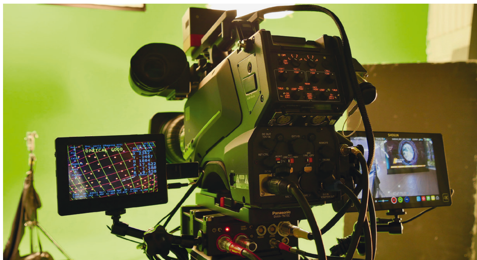
Ross a, durant l'été, organisé des démonstrations de sa technologie de studio virtuel. Ici une caméra de plateau Panasonic 4K équipée du système de tracking Mosys.
