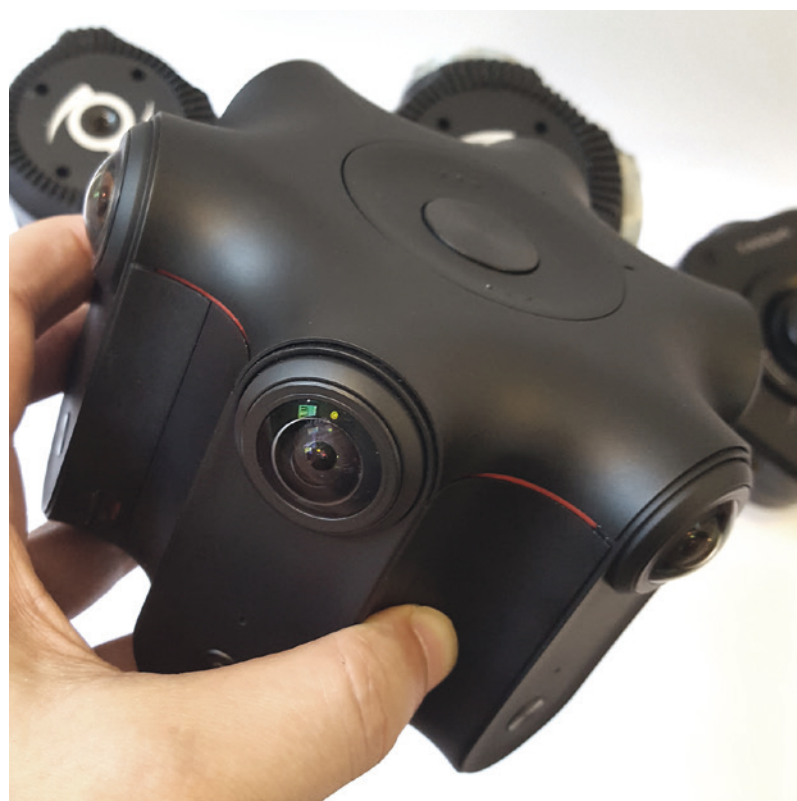
L'ingénieuse disposition radiale des optiques de la KANDAO OBSIDIAN S.
