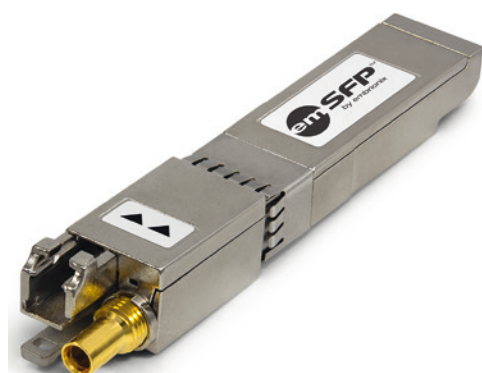
Un module SFP hybride avec une liaison pour câble coaxial et une seconde pour fibre optique. © Embrionix
