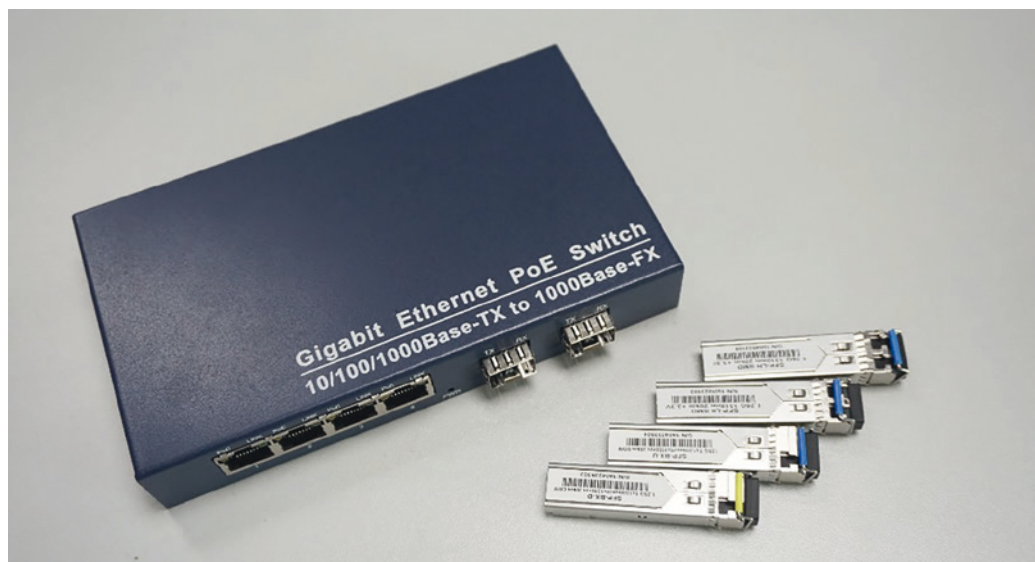
Les modules SFP servent à adapter le connecteur fibres optiques aux caractéristiques de la liaison. © Aliexpress
