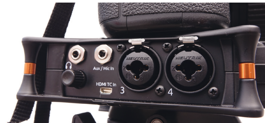
Sur la face droite de la MixPre-6, on trouve les entrées XLR 3 et 4, l'entrée Aux sur minijack, l'entrée micro HDMI (TC et Rec Trigger), la sortie casque et la molette multifonction. © Benoît Stefani
