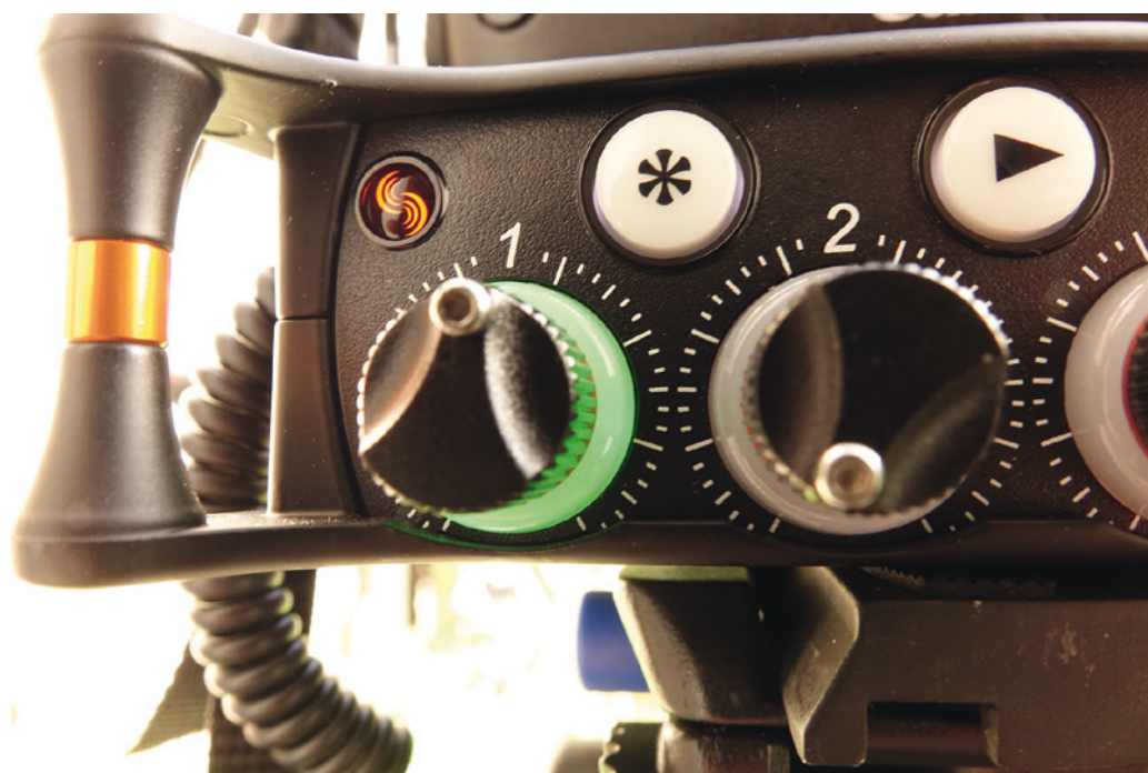
Les anneaux lumineux qui entourent les potentiomètres se colorent en vert, orange ou rouge en fonction du niveau reçu à l'entrée, une indication pour ajuster le niveau d'entrée préfabrés sans doute plus conviviale que la diode d'antan. © Benoît Stefani
