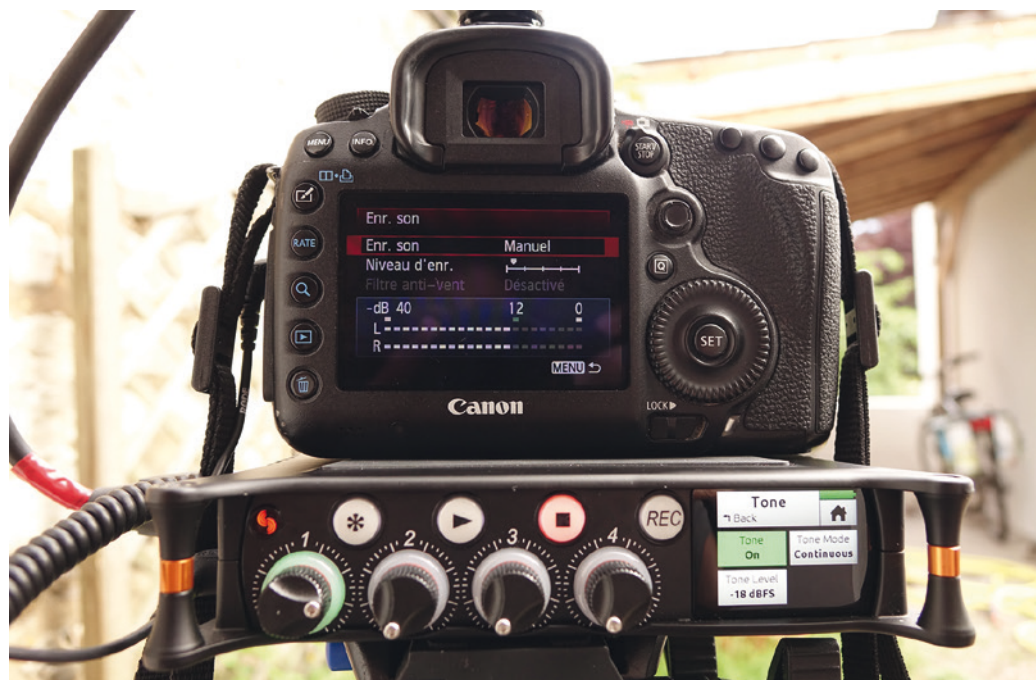
La calibration des niveaux, ici avec un Canon 5D MK III, est grandement facilitée par le générateur de 1 000 Hz intégré à la MixPre. © Benoît Stefani
