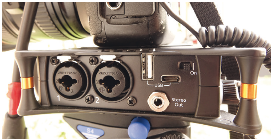
La face gauche reçoit les deux premières entrées XLR Combo Jack, l'USB-A pour le clavier, l'USB-C pour l'alimentation et à la liaison avec l'ordinateur, la sortie en minijack et le marche-arrêt. © Benoît Stefani
