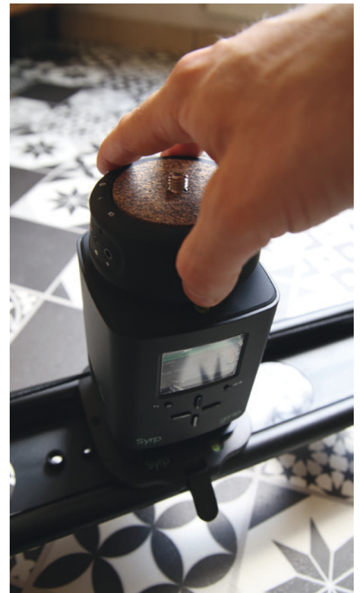
Fixation d'un Génie mini sur un Génie.
