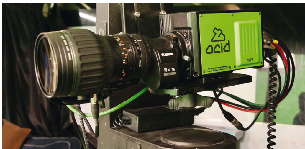
Caméra ACID de Ross dédiée à l'incrustation haut de gamme avec un traitement 4:4:4:4.
