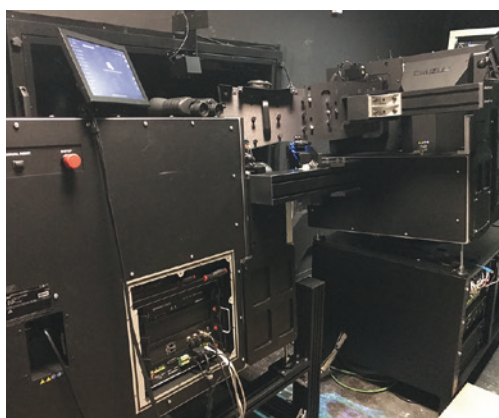
Cabine de projection de la salle Dolby Cinema à Barcelone avec deux projecteurs Christie Laser 6P !
