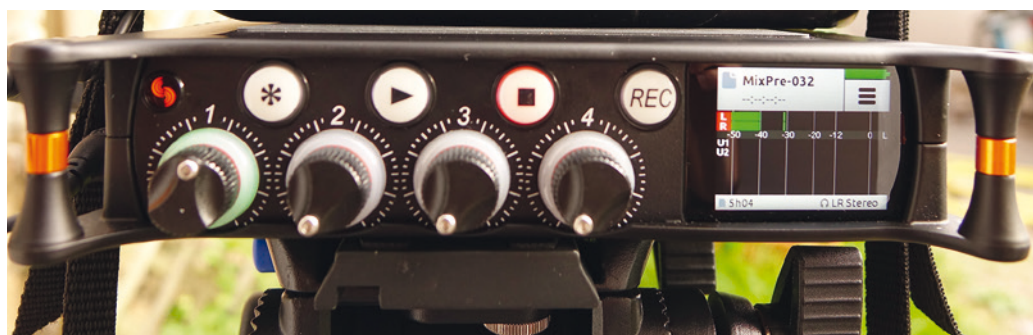
La MixPre-6 impressionne par sa compacité pour une machine dotée de quatre entrées XLR : à peine quatre centimètres d'épaisseur pour un poids d'un peu plus de 500 grammes. Notez à droite le petit écran LCD couleur tactile qui participe grandement à la facilité d'utilisation. © Benoît Stefani
