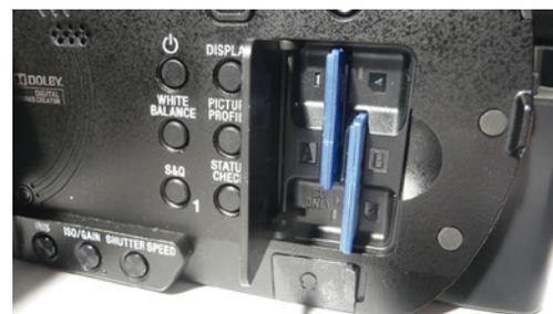
Deux slots pour cartes mémoire, compatibles avec les cartes SDXC/SDHC, et Memory Stick PRO Duo (Mark 2)/PRO-HG Duo. Enregistrement en mode « relais » pour augmenter l'autonomie d'enregistrement ou mode « simultané » pour avoir une copie de sauvegarde.
