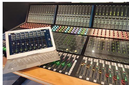
Le prototype de la console Stagetec Avatus : noter les écrans tactiles insérables au milieu des bacs faders et knobs.
