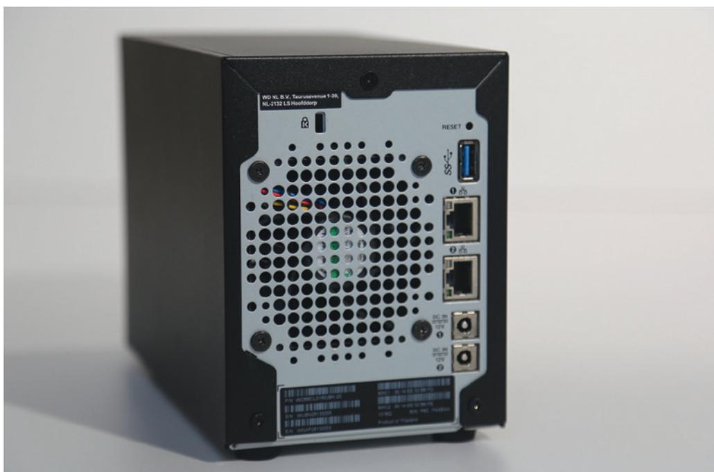
Une connectique Ethernet, deux ports Gb et des ports USB pour copier des contenus de DD externe.
