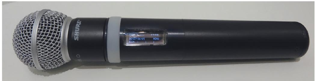
Compatible entre autres avec les capsules Shure, l'émetteur main Zaxcom ZMT3 HH est également capable de travailler en mode filaire. © B Stefani
