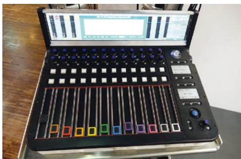
Encore au stade de prototype, la surface de contrôle Cantares permettra de piloter les Cantar X3 et Mini. © B Stefani
