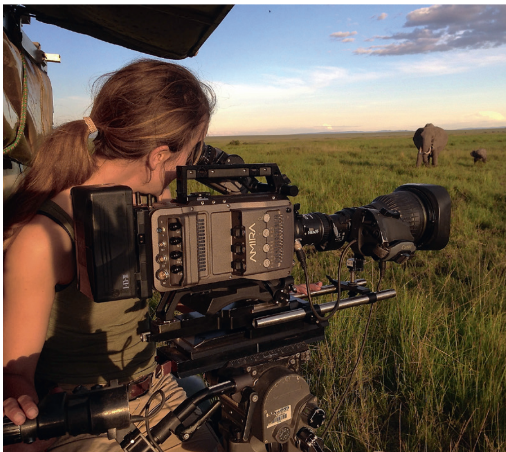
L'Amira d'Arri avec sa nouvelle mise à niveau, elle enregistre en UHD à partir d'un capteur 3,2 K.
