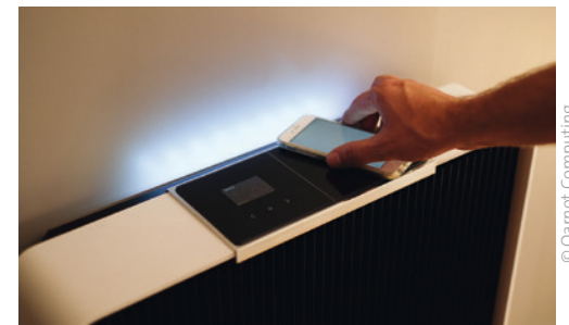
Qarnot Computing propose des radiateurs numériques comme composants de la ferme de rendu.
