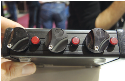
Le module VCP M3 de Kortwisch apporte trois préamplis micros utiles à certains possesseurs de mixeur-enregistreur Sound Devices...
