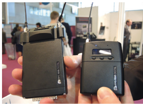
GAUCHE : La liaison HF numérique Audio Ltd comprend le récepteur Diversity DX-1010, et l'émetteur de poche RX 1010. DROITE : Capable de recevoir aussi bien la modulation FM analogique des anciens émetteurs que le signal des émetteurs numériques figurant au catalogue du constructeur allemand, le récepteur Diversity double canal Sennheiser EK 6042 (à droite) est photographié ici avec l'émetteur de poche numérique SK 9000 (à gauche).
