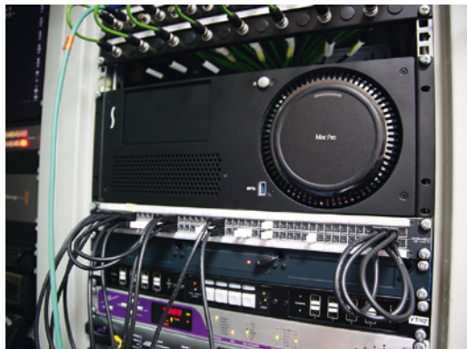
Nouveau Mac Pro dans son rack Sonet Technology utilisé pour Avid Pro Tools
