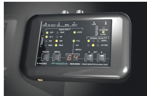
Le module de poche Madi-Moni de Direct Out Technologies permet d'écouter et de vérifier la qualité d'un signal Madi.
