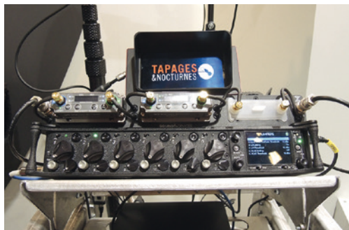
Fixé au dessus de la 688, le dock CL6 accueille jusqu'à trois doubles récepteurs HF et en simplifie l'exploitation.
