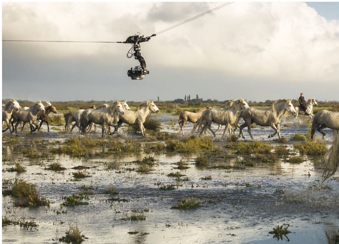
ACS France fut l'une des prestataires techniques du film. Le CableCam pour filmer les chevaux en Camargue.
