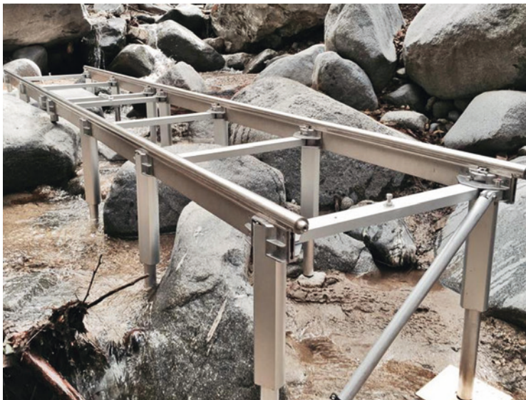
Travelling Precision Levelling Tracks de Panther avec ses pieds télescopiques.
