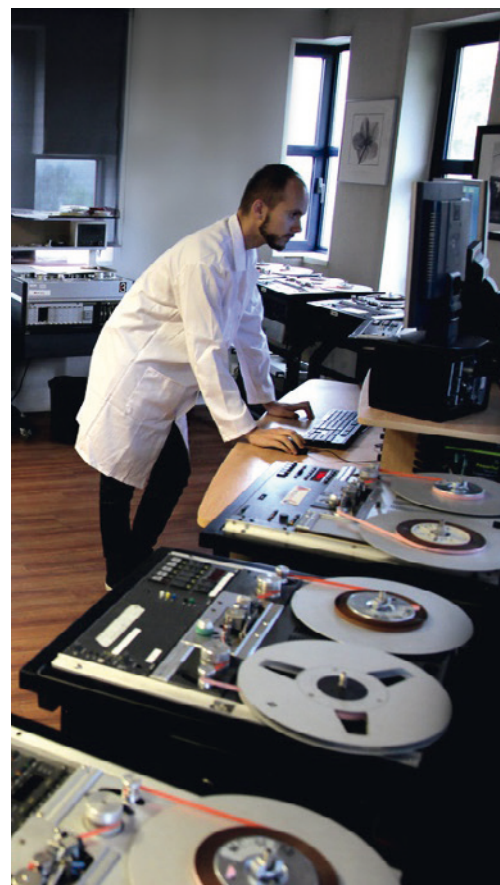
L'une des deux salles de numérisation audio avec ses huit magnétophones Studer fonctionnant en parallèle.
