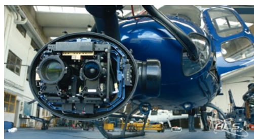
Adapté sur une tête Shotover K1, la possibilité de filmer avec deux caméras, pour au final filmer avec 2 optiques totalement différentes.
