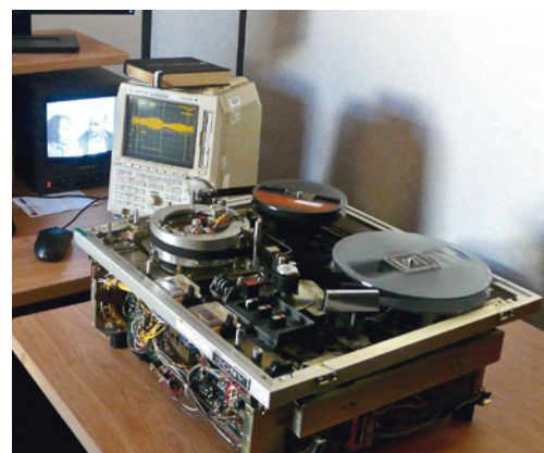
Malgré ses 40 ans, le magnétophone Sony AV-3670 sert à la numérisation de bandes vidéo noir et blanc EIAJ.
