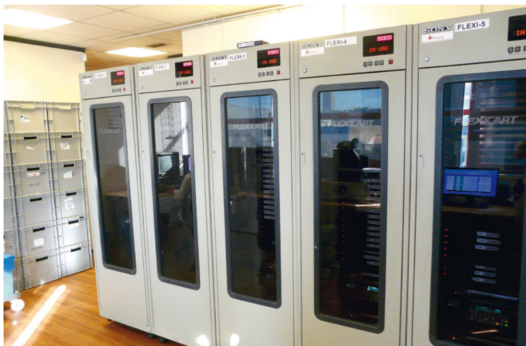
Les cinq robots Flexicart de la salle de numérisation automatique des cassettes Betacam.
