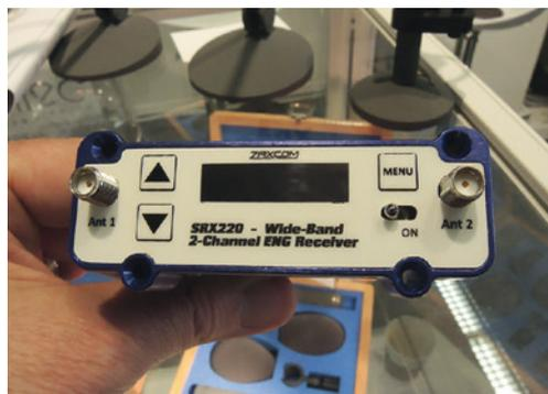
Le nouveau récepteur Zaxcom SRX220 est un modèle slot-in compatible Unislot et Superslot particulièrement léger.
