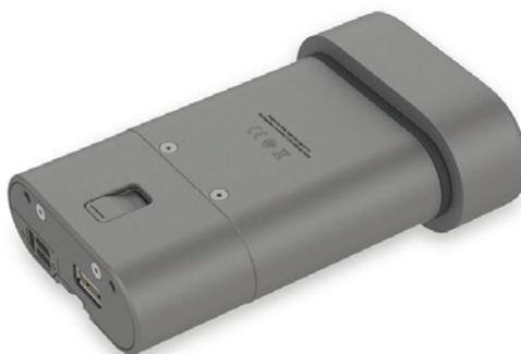
La batterie et la mémoire flash sont intégrées dans un même bloc qui se fixe à l'arrière de l'Ozo.
