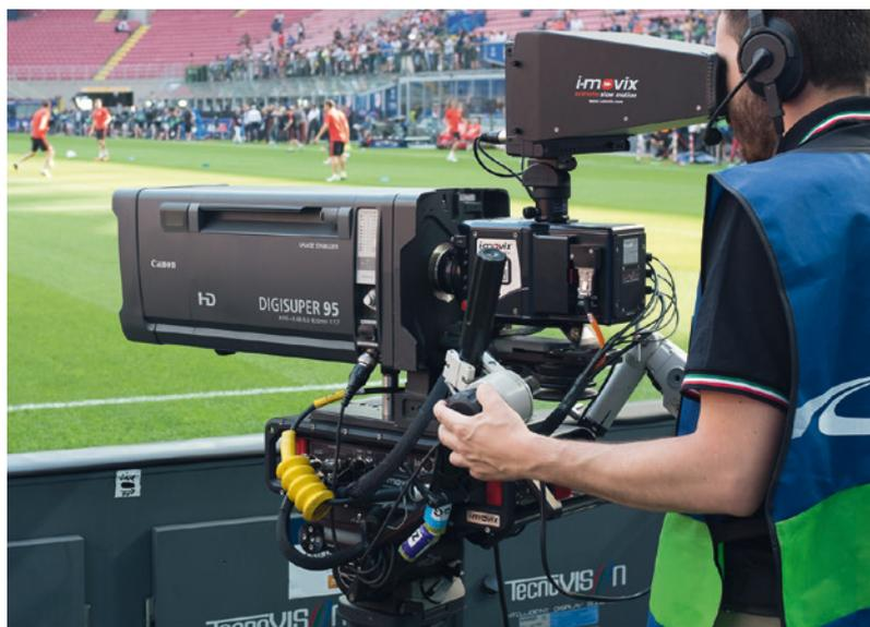
i-Movix Infinite, première caméra hautes vitesses avec enregistreur attaché (sous la caméra).
