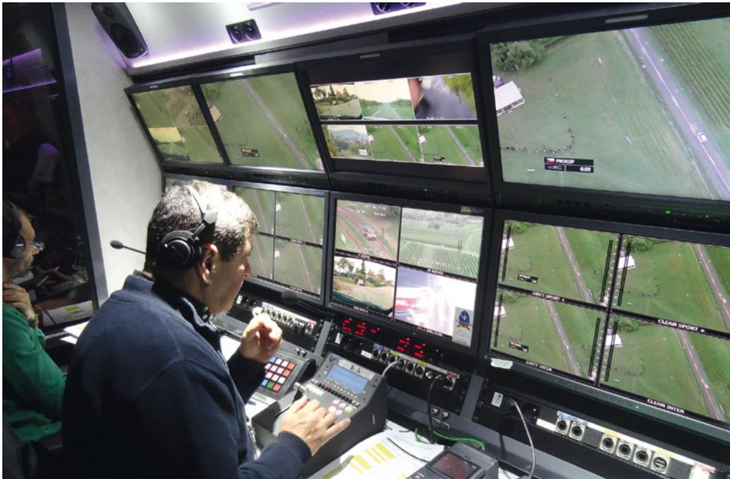
Un opérateur LSM en action. La fonction a connu une évolution majeure avec la mise en réseau des systèmes de ralentis.
