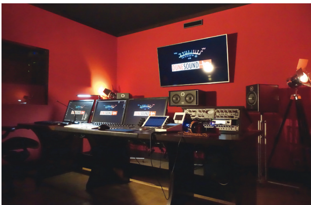
Le studio C de Dune Sound : Architecturé autour d'un Pro Tools 12 HDX piloté par une Avid S3 agrémentée du nouveau Pro Tools Dock. Le monitoring 5.1 Focal (Solo 6Be en façade, CMC 50 derrière+ Sub) est optimisé par un système Trinnov D-Mon commandé par une Colin Broad TMC-1 D-Mon.
