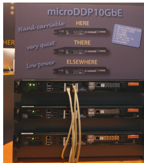
MicroDDP10GbE est une nouvelle génération de disques SSD ultra-rapides connectables en réseau qui tiennent dans un rack 1U.
