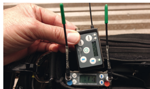
L'émetteur SSM devant le récepteur double Diversity Lectrosonics SRC, dont l'affichage permet ici de surveiller les niveaux audio, HF, ainsi que l'alimentation. © Benoît Stefani
