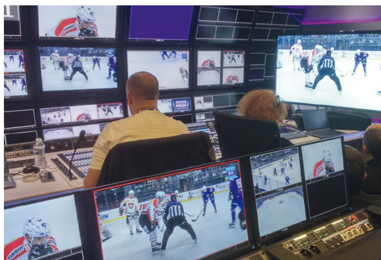
Faute de moniteur disponible pour le moment, seul le retour programme, via un prototype LG-E7, offrait le rendu en HD-HFR 100p.
