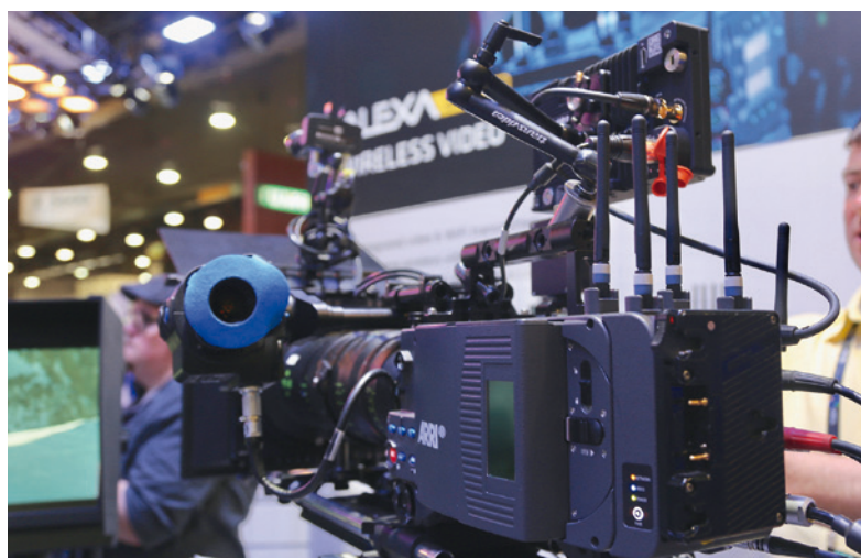
L'émetteur WiFi ARRI propose, outre la transmission du signal pour le monitoring, des options qui changent l'approche des tournages, tels la gestion de la colorimétrie et le contrôle à distance de la caméra avec l'application Alexa Web Remote.
