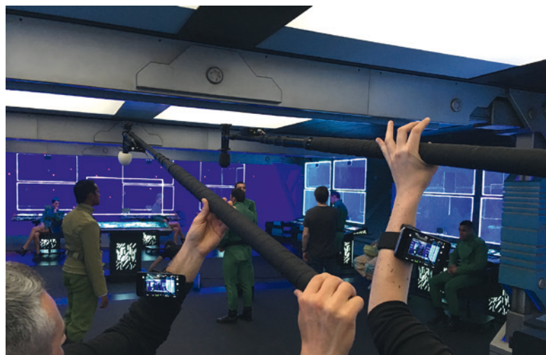
Système de retour vidéo sur iPod pour les perchmen. © Valérien SAS – TF1 Films Production
