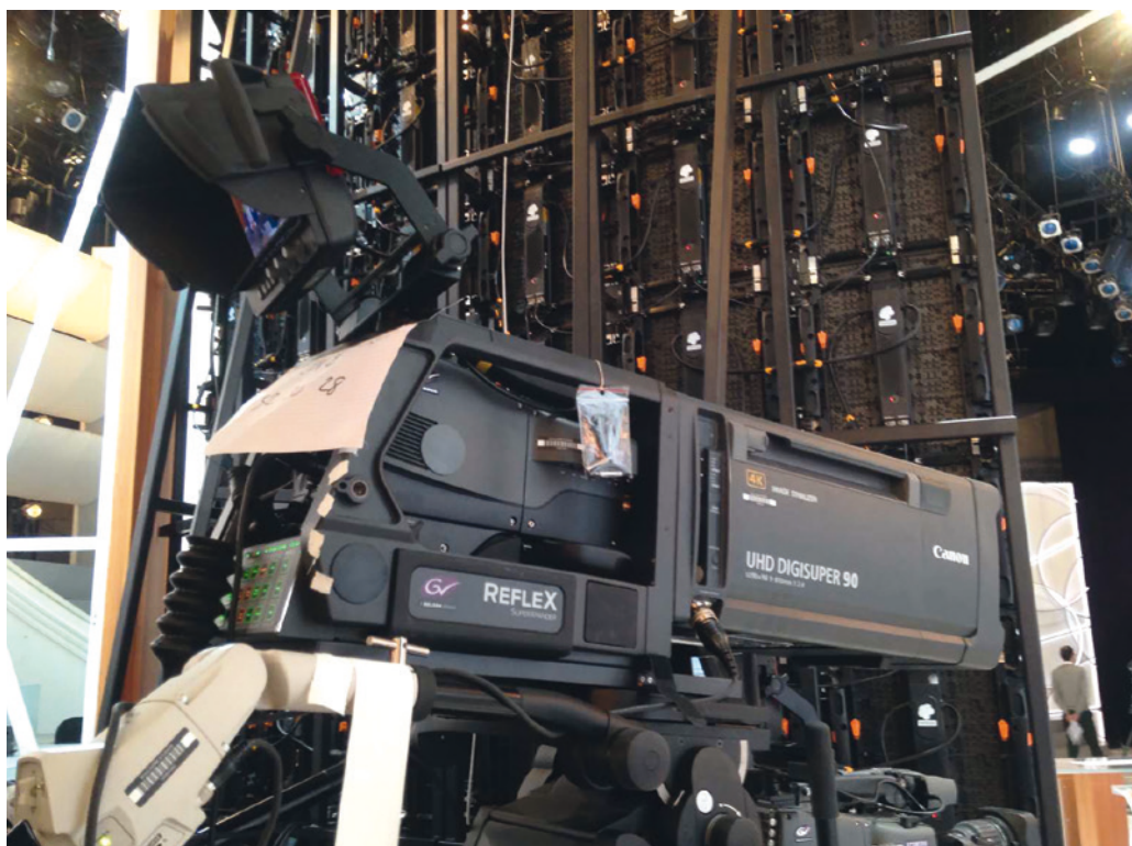
L'une des dix nouvelles caméras Grass Valley LDX 86 qui équipent le plateau A.
