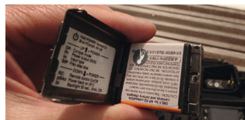
La trappe ouverte donne un accès au petit accu Lithium-Ion de 3.7 V emprunté à l'industrie photo. Noter, à gauche, l'antisèche qui rappelle l'accès aux menus de configuration.
