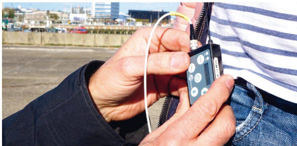
L'émetteur Lectrosonics SSM en situation. Noter la connectique micro Lemo trois broches. © Diane Sorin
