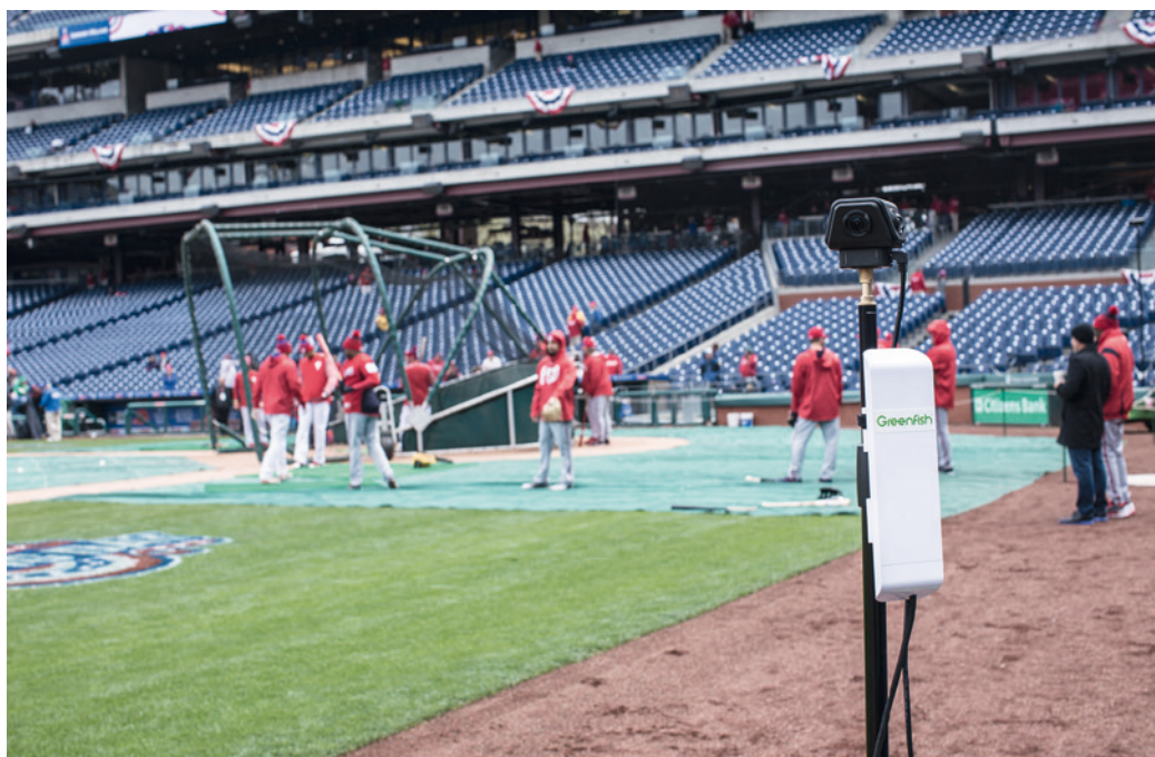
La caméra Orah 4i développée par Videostitch fait partie de cette nouvelle génération de caméras 360° dédiées au Live qui arrivent sur le marché avec un module de stitching automatique intégré.
