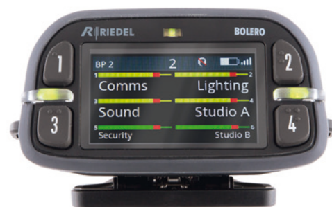
Le Bolero de Riedel est un système d'intercom extensible, mobile et basé sur la norme DECT, utilisant la plage de fréquences 1,9 GHz.
