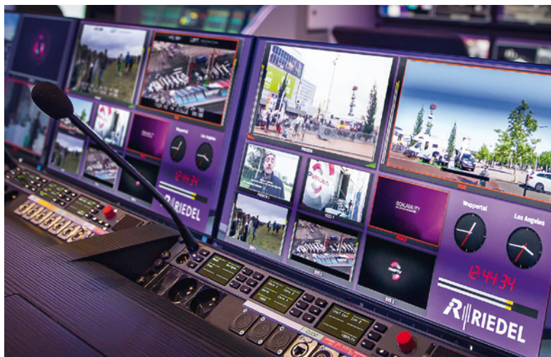
Le MediorNet MultiViewer peut traiter jusqu'à 18 signaux.
