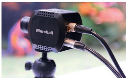
Caméra CV380-CS de Marshall est modèle encore plus compact pour tourner en 4K et UHD jusqu'à 30 ips/ Progressif ou Entrelacé. © Nathalie Klimberg
