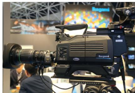
Caméra Ikegami HDK 99, une nouvelle caméra 4K HDR avec un capteur 3 CMOS. © Nathalie Klimberg
