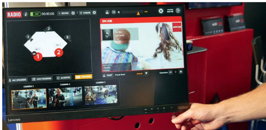
Multicam Systems montre une nouvelle fonctionnalité consistant à faire un tracking des locuteurs et à optimiser automatiquement le cadrage quand une personne bouge à l'intérieur du cadre.
