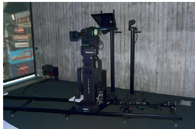
La caméra Panasonic AJ-PX800 est montée sur une tête robotisée et se déplace grâce à un travelling Telemetrics. © PA Taufour
