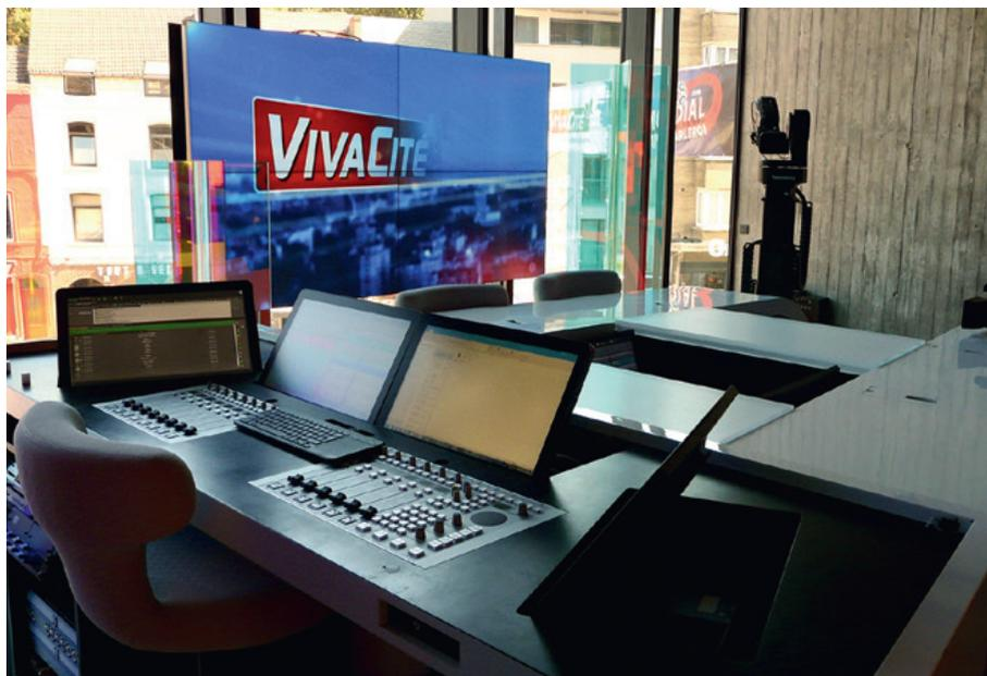
En configuration radio, l'ingénieur du son prend la place du présentateur et mixe le son avec les deux surfaces de contrôle DHD Audio. © PA Taufour
