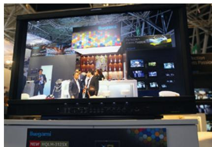
Le Moniteur HQLM-3125X Ikegami est équipé d'une dalle LCD rétroéclairée affichant une belle luminosité de 1 000 nits et intégrant les courbes HDR HLG et PQ. © Nathalie Klimberg
