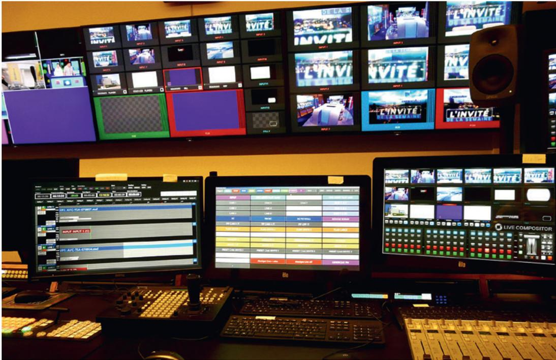
En régie, le réalisateur rappelle les configurations des équipements grâce à l'écran tactile au centre, tandis que l'écran de gauche affiche l'avancement du conducteur géré par Live Assist. L'écran à droite affiche les panneaux de commande de divers équipements, ici le pupitre du Live Compositor. © PA Taufour
