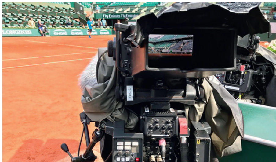
Pour la captation en UHD, France Télévisions avait installé quatre caméras Sony HDC-4300. Elles fournissaient simultanément un signal HD 1080p50 Rec.709 et UHD 2160p50 BT.2020. © France Télévisions
