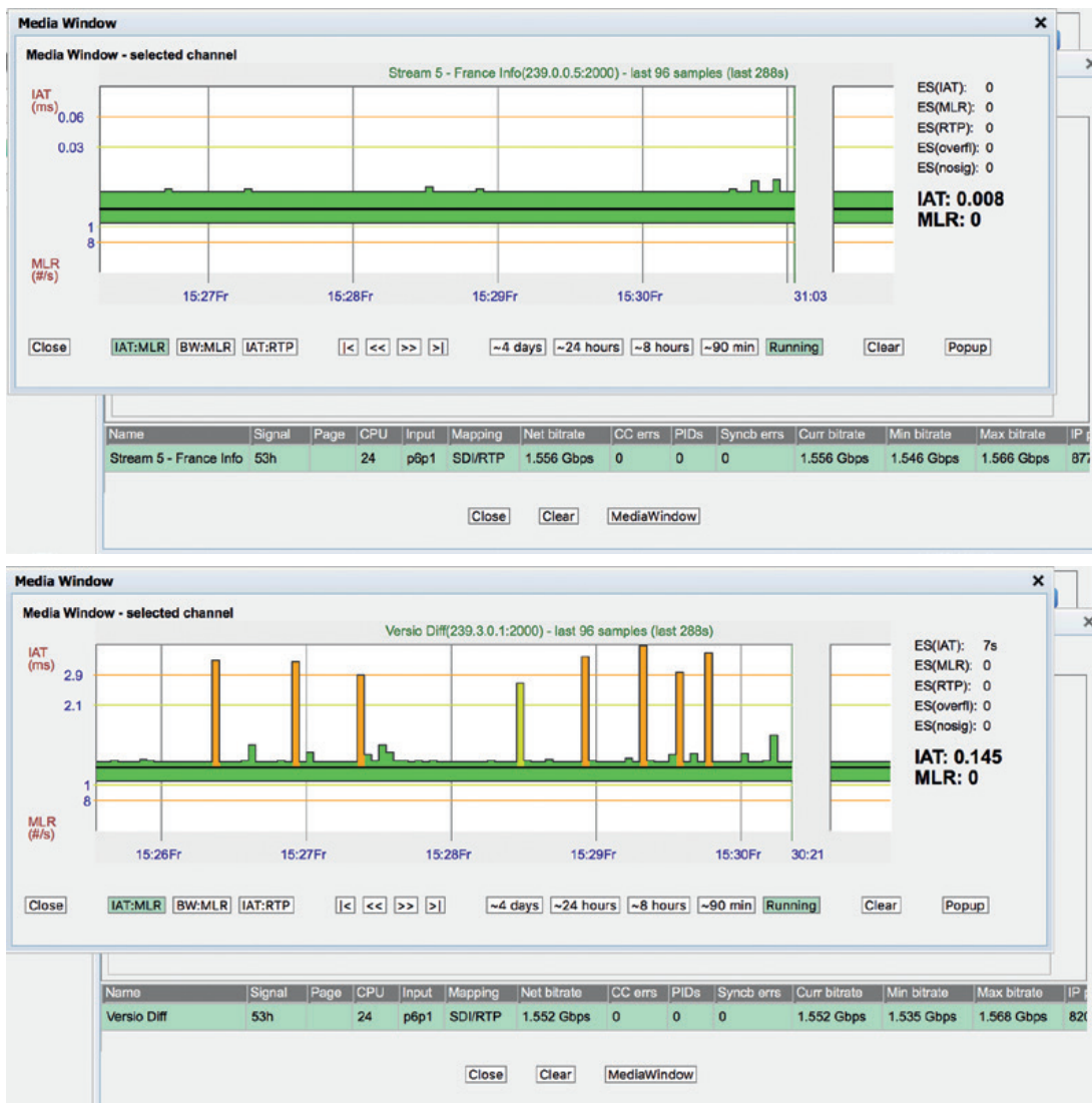
Valeurs de l'IAT mesurées sur le réseau pendant quelques minutes. En haut, sur une configuration hardware pure, en bas, sur l'infrastructure virtuelle. © France Télévisions
