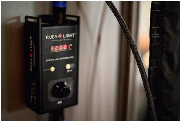
Le variateur de chez Rubylight. On peut maintenant varier l'intensité et la température de couleur des Boas comme bon nous semble.
