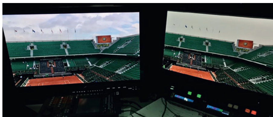
En régie, le poste de contrôle qualité UHD avec à gauche le départ UHD HDR HLG et à droite le final HD. © France Télévisions
