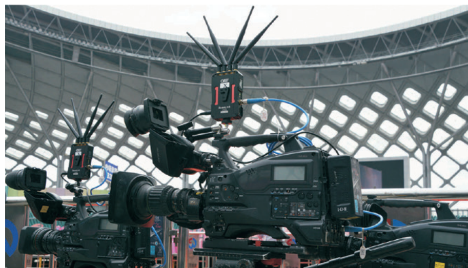
CVW Beamlink Squad de chez Linear Technologie. Emetteur HF HDSI en version 4 canaux pour envoyer la même image vers quatre récepteurs.
