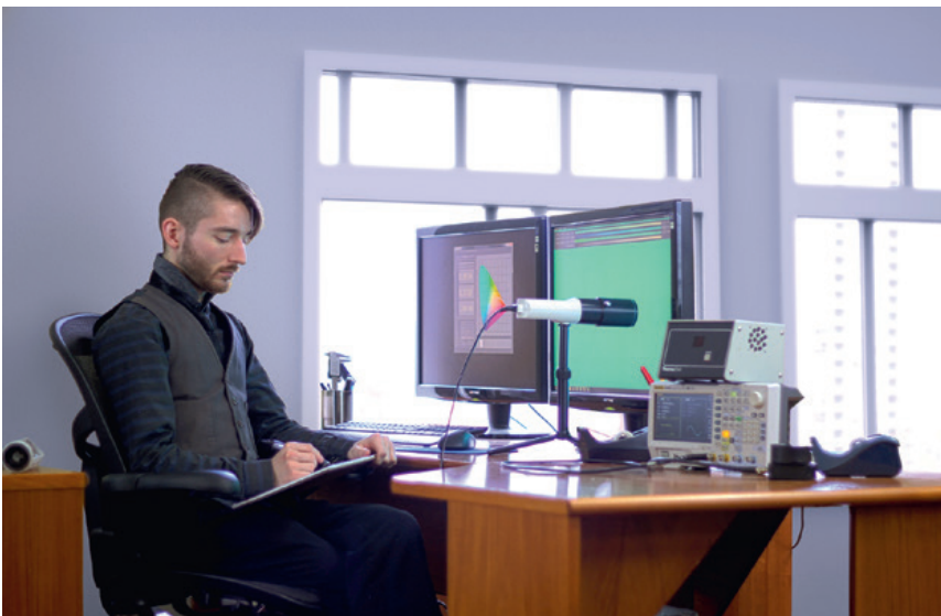
Mesure d'un écran pour calibration avec une sonde Klein K10A. © Klein
