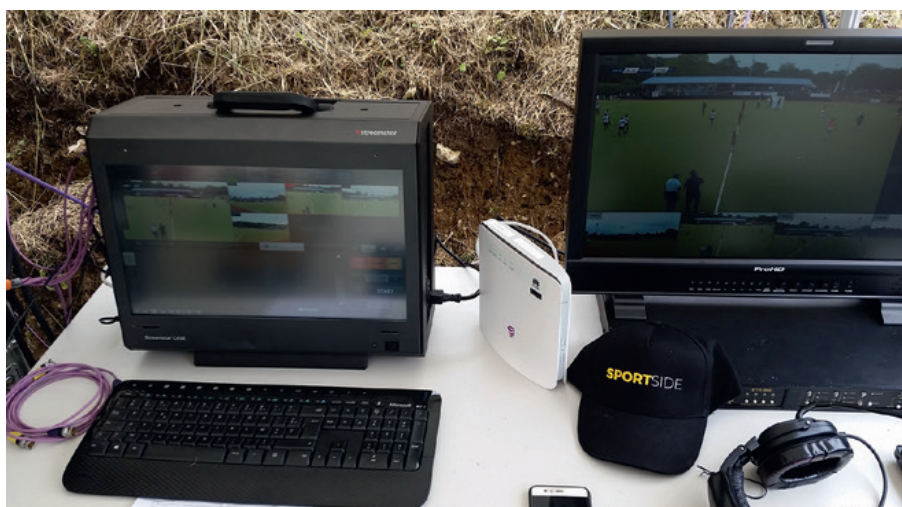
Le Streamstar CASE710 permet de relier jusqu'à 6 sources vidéo externes.
