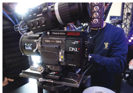
La DXL-M au Micro Salon, avec une optique Primo X à motorisation interne et sans bague.
