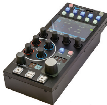
Le panneau RCP de CyanView est équipé d'un écran tactile de 3,5 pouces affichant des menus en mode contextuel. © CyanView
