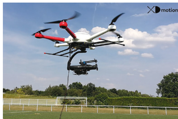
Le drone captif est un nouvel outil qui permet de filmer sur de longues durées (alimentation et vidéo passent par le même câble). Il est même possible de fixer de la lumière sur le drone. © XD Motion
