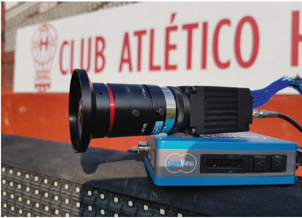
L'interface Cy-CIO établit un lien entre les ports série des caméras et le réseau IP du panneau RCP. © CyanView
