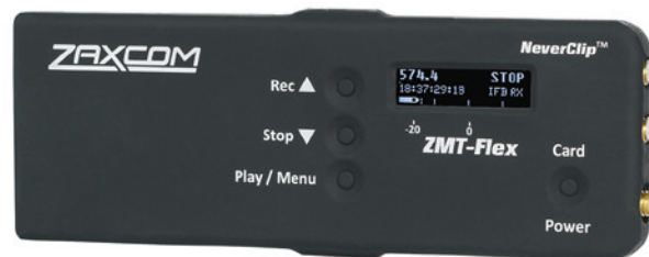
L'étonnant émetteur Zaxcom ZMT3 Flex reprend les caractéristiques de la série ZMT dans un boîtier souple revêtu de silicone conçu pour équiper les sportifs.
