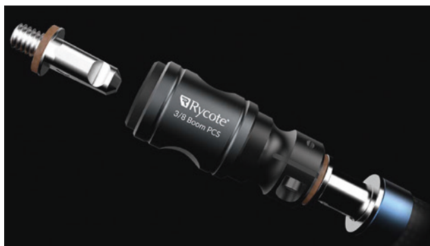
Rycote PCS : un ensemble comprenant un embout mâle côté suspension et un connecteur mécanique côté perche dont le but est de permettre au perchman de changer rapidement de microphone par simple encliquetage.
