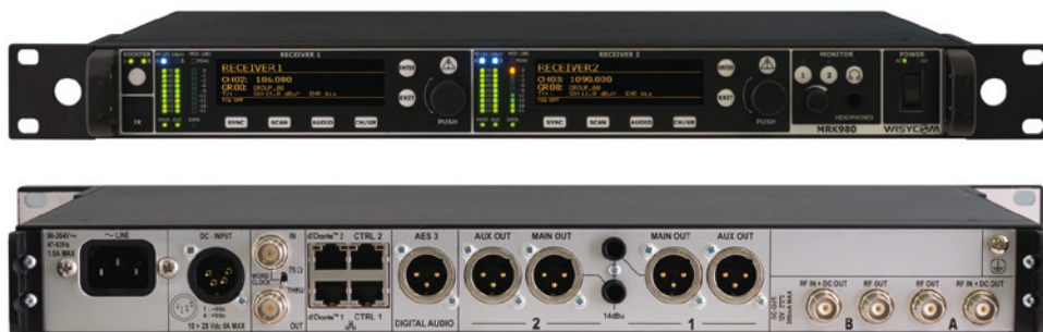
Successeur du MRK 960, le Wisycom MRK 980 est le nouveau récepteur fixe double canal True Diversity de la marque italienne.
