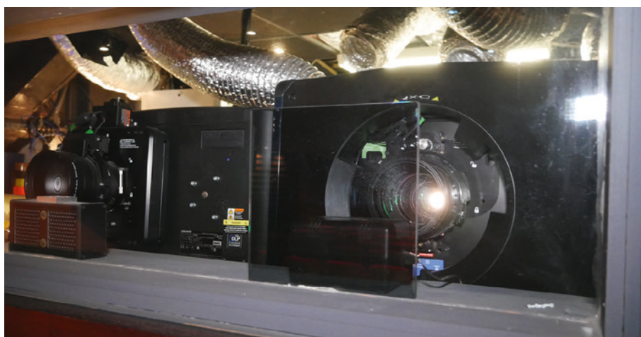
Le Club de l'Étoile s'est équipé d'un projecteur laser 4K Christie CP-4325 doté d'une optique UHC.
