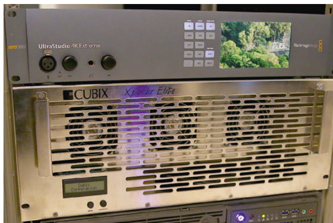
Chassis d'expansion pour cartes graphiques Cubix et boîtier E/S Blackmagic.
