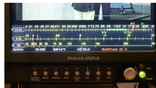
L'assistant opérateur peut connaître très vite la distance de son sujet et ajuster sa bague de point en conséquence.
