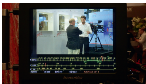
L'assistant opérateur peut connaître très vite la distance de son sujet et ajuster sa bague de point en conséquence.
