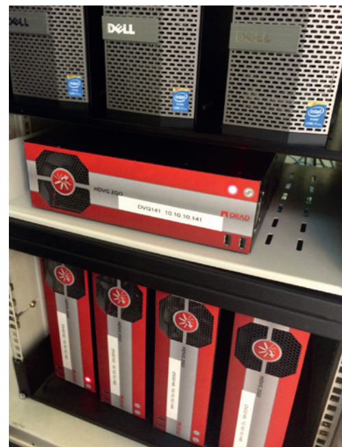
La plateforme HDVG Orad assure l'infographie dynamique, et l'affichage sur les différents displays, y compris le mur géant.
